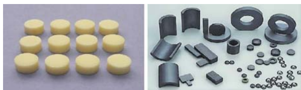
Рис. 5. Резонатори з високочастотних НВЧ-діелектриків (зліва) і феромагнітних матеріалів НВЧ-діапазону (справа)
