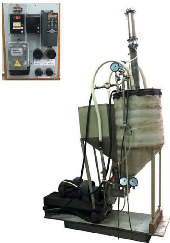
Рис. 6. Зовнішній вигляд експериментальної універсальної установки для виробництва біоетанолу із застосуванням методу ДІВЕ
