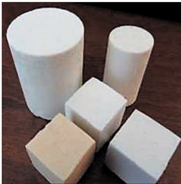
Рис. 4. Зразки фосфатної кераміки (калій-магнієвий фосфат \text{KMgPO}_4 \cdot 6\text{H}_2\text{O} ) для ствердіння рідких радіоактивних відходів
