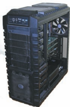
Інпарком_pg 1 вузол 8 процесорних ядер 48 ГБт оперативної пам'яті 3 терафлопсів 2 GPU Nvidia Tesla K40
