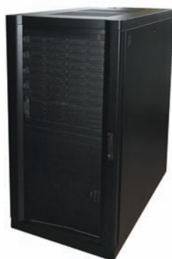
Інпарком_g 4 вузли 32 процесорних ядра 96 ГБт оперативної пам'яті 5 терафлопсів 8 GPU Nvidia Tesla M2090
