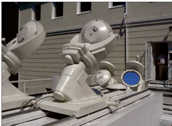
Рис. 1. Целостатна установка телескопа АЦУ-5 Головної астрономічної обсерваторії НАН України
