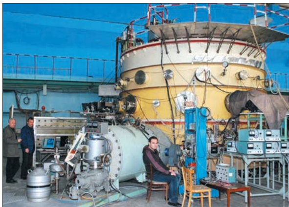
Стеларатор-торсатрон «Ураган-3М» (ННЦ ХФТІ)
