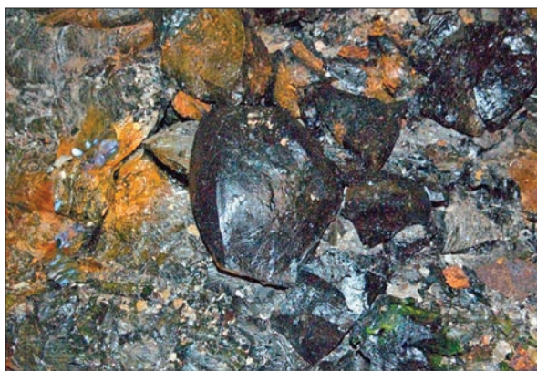
Деградація паливовмісних матеріалів на об'єкті «Укриття»
