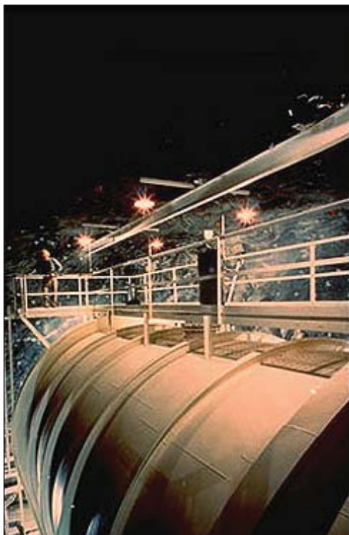
Рис. 1. Установка Девіса для реєстрації сонячних нейтрино у шахті Хоумстейк (Південна Дакота, США). Джерело: Tufts University ( http://www.tufts.edu/ )
