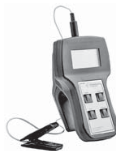
Рис. 6. Портативний флуориметр «Флоратест» для експрес-діагностики стану рослин
