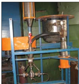
Рис. 1. Експериментальні установки для дослідження технології струминного подрібнення: UCI-20 і UCI-0,2
