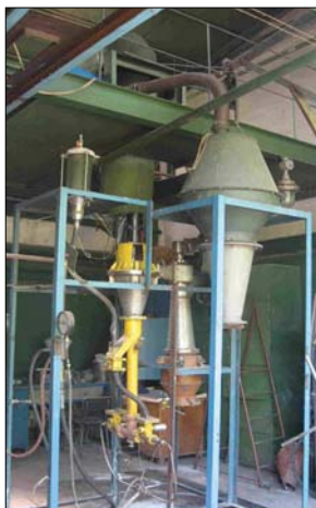
Рис. 1. Експериментальні установки для дослідження технології струминного подрібнення: UCI-20 і UCI-0,2
