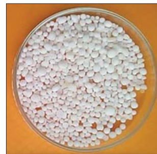
Рис. 1. Сорбент, одержаний послідовним нанесенням фосфату цирконію на силікагель
