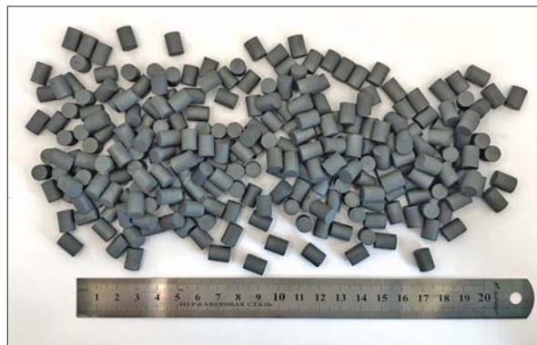
Рис. 5. Зовнішній вигляд таблеток карбіду бору
