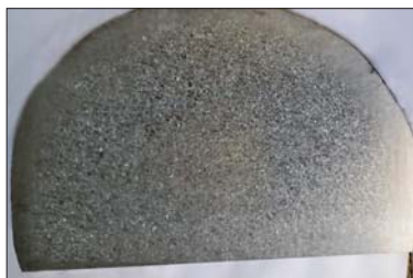
Рис. 2. Зливки сплаву алюмінію-титану і його макроструктура
