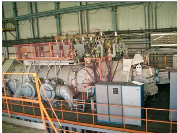
Рис. 1. Універсальна промислова електронно-променева установка UE5812. ДП «НВЦ «Титан» ІЕЗ ім. Є.О. Патона»
