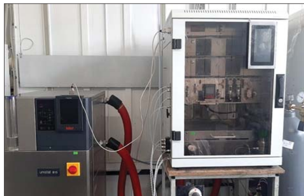
Рис. 3. Зовнішній вигляд фотохімічного проточного реактора
