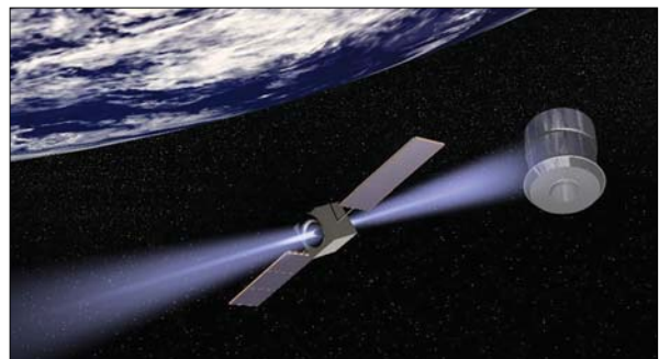
Рис. 3. Видалення космічного сміття за допомогою іонного променя
