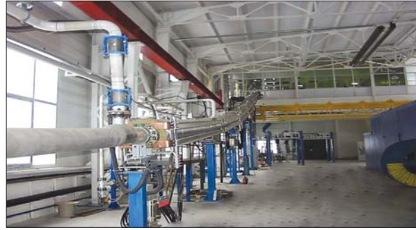
Рис. 4. Технологічна лінія похилого типу для нанесення тришарової ізоляції на струмопровідну жилу надвисоковольтних кабелів
