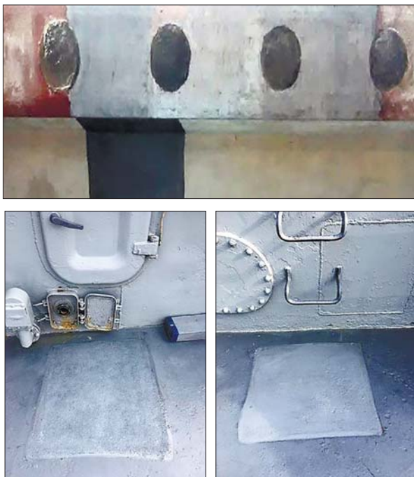
Рис. 4. Захисні покриття метал/бетон/поліуретан та метал/бетон/поліуретан-поліепоксид, а також експериментальний зразок покриття на верхній палубі фрегата станом на березень 2021 р. повністю зберегли свої властивості (Херсонський державний завод «Палада»)
