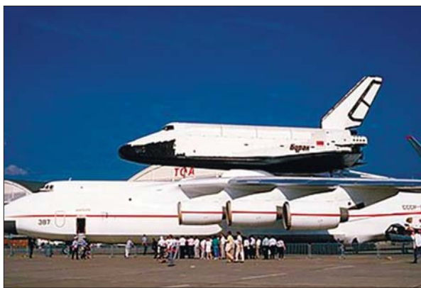
Рис. 2. Встановлений на літаку-носії Ан-225 «Мрія» орбітальний корабель багаторазового використання «Буран» (можна бачити теплозахисні плитки)
