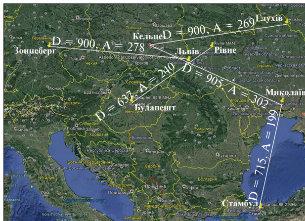
Рис. 2. Радіотраси мережі реєстрації метеорних явищ: D — довжина, км, A — азимуту, градуси
