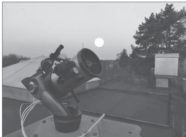
Рис. 1. Телескоп для позиційних спостережень: фотооб'єктив «Юпітер-9» діаметром 85 мм на гідуюальному монтуванні Meade DS2130
