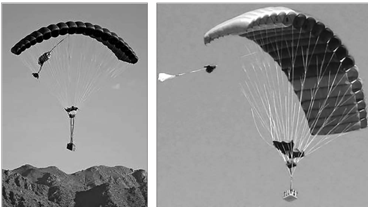
Рис. 11. Керована система точного повітряного десантування вантажів FireFly II® [10]
