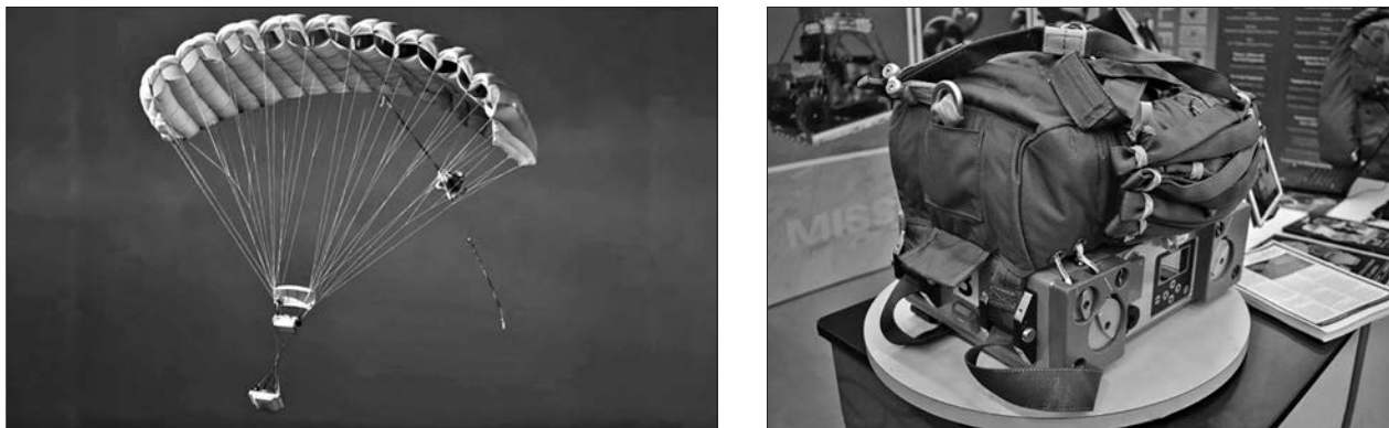
Рис. 10. Керована система точного повітряного десантування вантажів MicroFly II® [23]
