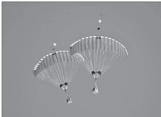
Рис. 7. Американська керована система десантування вантажів JPADS [2]
