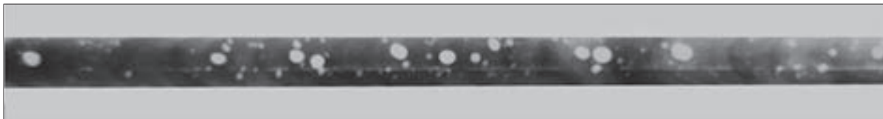
Рис. 1. Рентгенограма стикового з'єднання сплаву АМг6, отриманого електронно-променевим зварюванням на літаючій лабораторії в режимі зниженої гравітації (1/6)g (поверхня Місяця)
