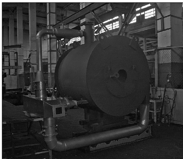
Рис. 6. Зовнішній вигляд горизонтального пальника для спалювання відходів деревини як резервного палива в топці котла ДКВР 2,5
