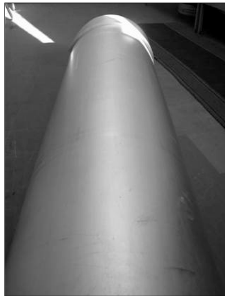
Рис. 2. Триметаллический магистральный трубопровод
