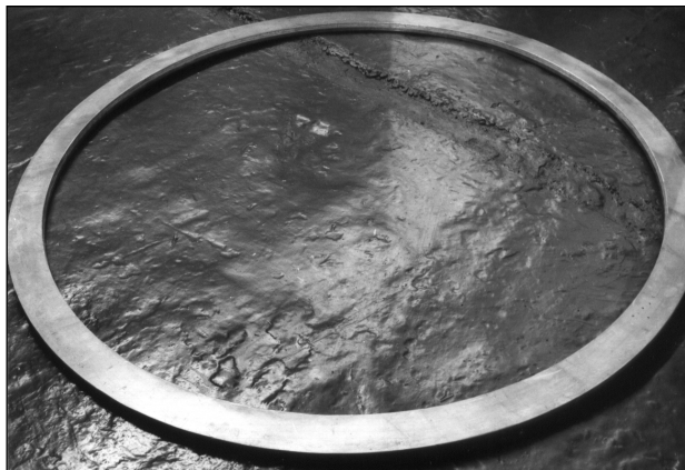
Рис. 1. Биметаллическое кольцо (сталь-алюминиевый сплав) под переходный элемент для соединения двигателя с топливным баком РКТ
