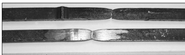
Рис. 7. Зварне з'єднання труби діаметром 51 × 3,5 мм після випробувань на розрив
