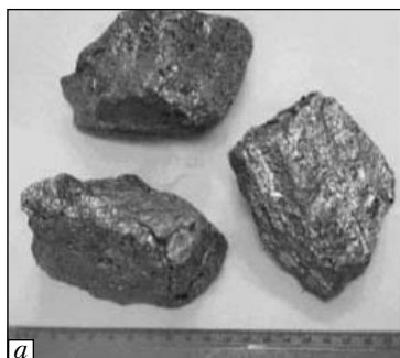
Рис. 4. Измельченный металлургический кремний: а – исходный кремний; б – фракция 1–3 мм; в – фракция менее 1 мм
