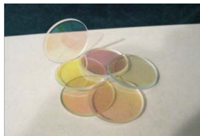
Рис. 3. Експериментальні зразки оптичних елементів для ІЧ вузькосмугового фільтра з багатошаровими покриттями на основі композитів \text{MgF}_2\text{-LuF}_3 і \text{ZnS-GdS} (ЦКБ "Арсенал")
