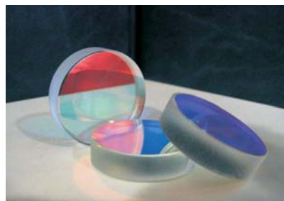
Рис. 2. Експериментальні зразки оптичних елементів для ІЧ спектроподілювача з багатошаровими покриттями на основі композитів \text{MgF}_2\text{-LuF}_3 і \text{ZnS-GdS} (ЦКБ "Арсенал")
