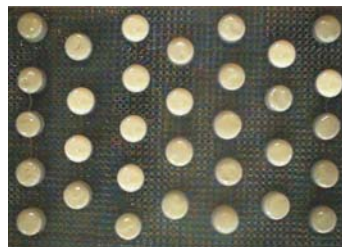
Рис. 1. Експериментальні зразки плівкоутворюючого матеріалу на основі композиту \text{MgF}_2\text{-LuF}_3
