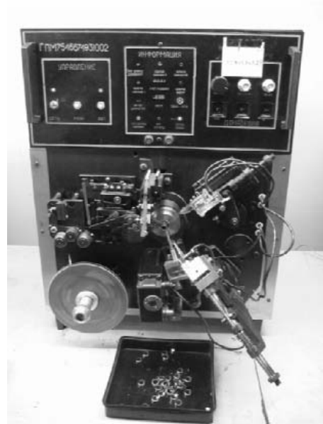
Рис. 3. Автоматизований станок для намотування магнітопроводів "Модуль-30"
