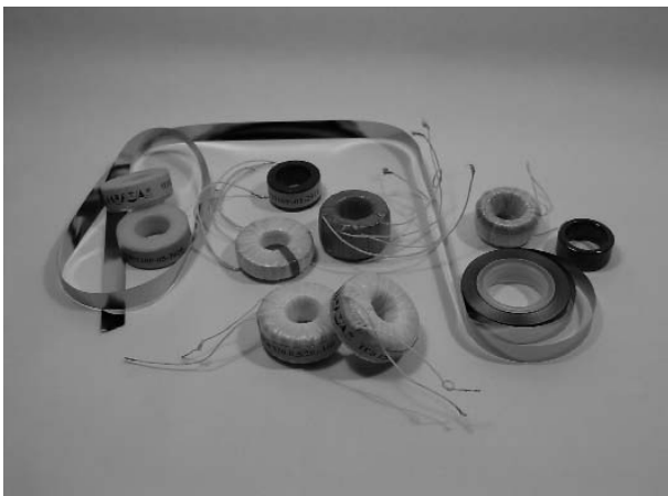
Рис. 8. Дослідні та дослідно-промислові партії вимірювальних трансформаторів струму різного призначення
