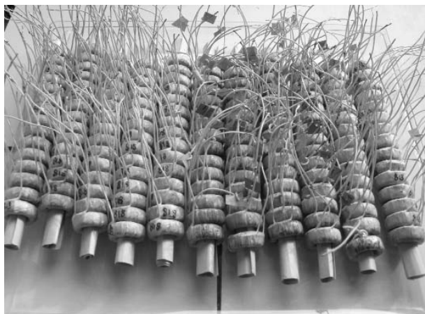
Рис. 8. Дослідні та дослідно-промислові партії вимірювальних трансформаторів струму різного призначення
