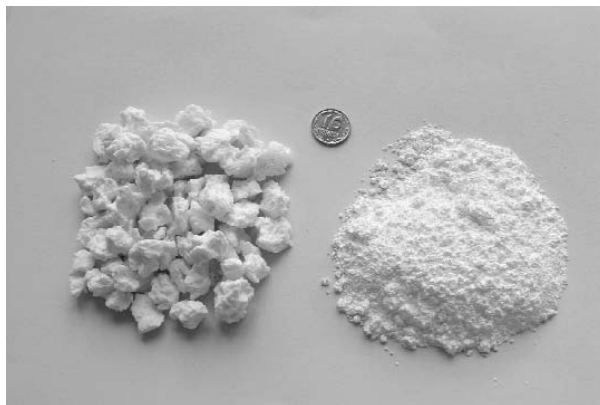
Рис. 1. Порошки гидроксида циркония, полученные по традиционной технологии (слева) и по разработанной в ДонФТИ НАНУ (справа)
