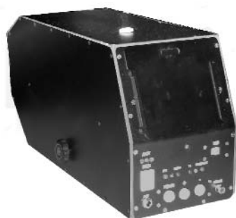
Рис. 3. Зовнішній вигляд розробленого та виготовленого тепловізора
