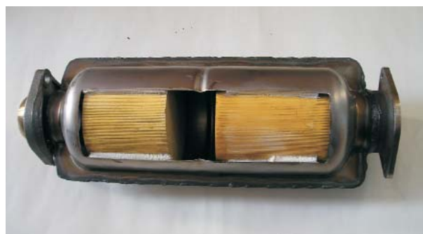
Рис. 4. Каталітичний нейтралізатор для автомобілів ВАЗ: а – загальний вид нейтралізатора і каталізаторних блоків; б – каталітичний нейтралізатор в розрізі
