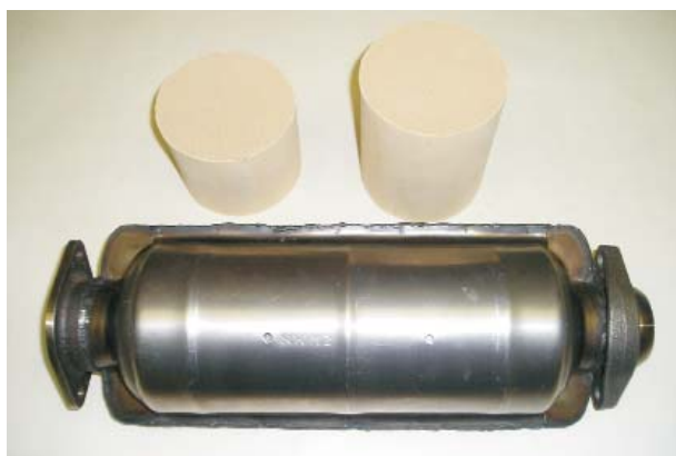
Рис. 4. Каталітичний нейтралізатор для автомобілів ВАЗ: а – загальний вид нейтралізатора і каталізаторних блоків; б – каталітичний нейтралізатор в розрізі
