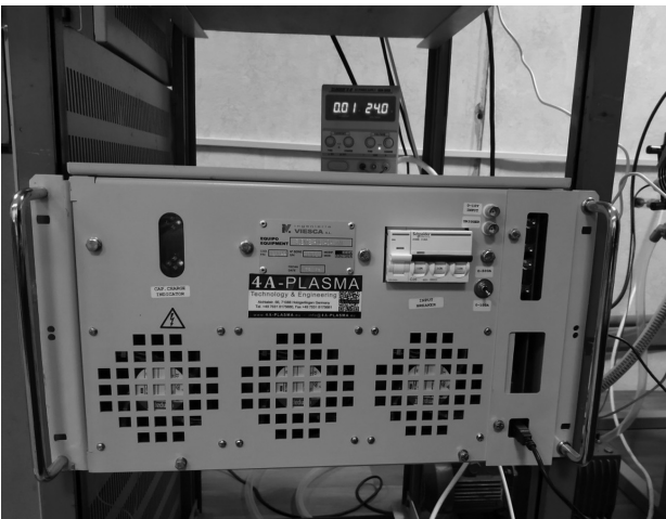
Fig. 8. 4A-PLASMA hip-V-6 kW power supply unit
