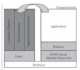
Fig. 3. Configuration of «Inparcom-pg» system software
