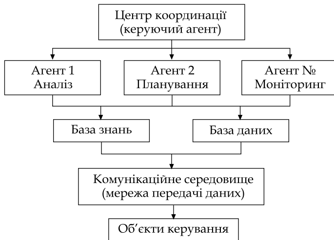
Рис. 2. Узагальнена архітектура багатоагентної системи інтелектуального керування в розподіленому комп'ютерно-комунікаційному середовищі
