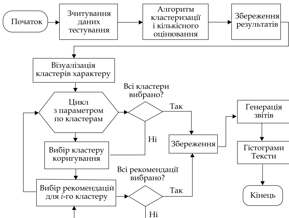
Рис. 3. Принципова блок-схема основного алгоритму роботи програми
