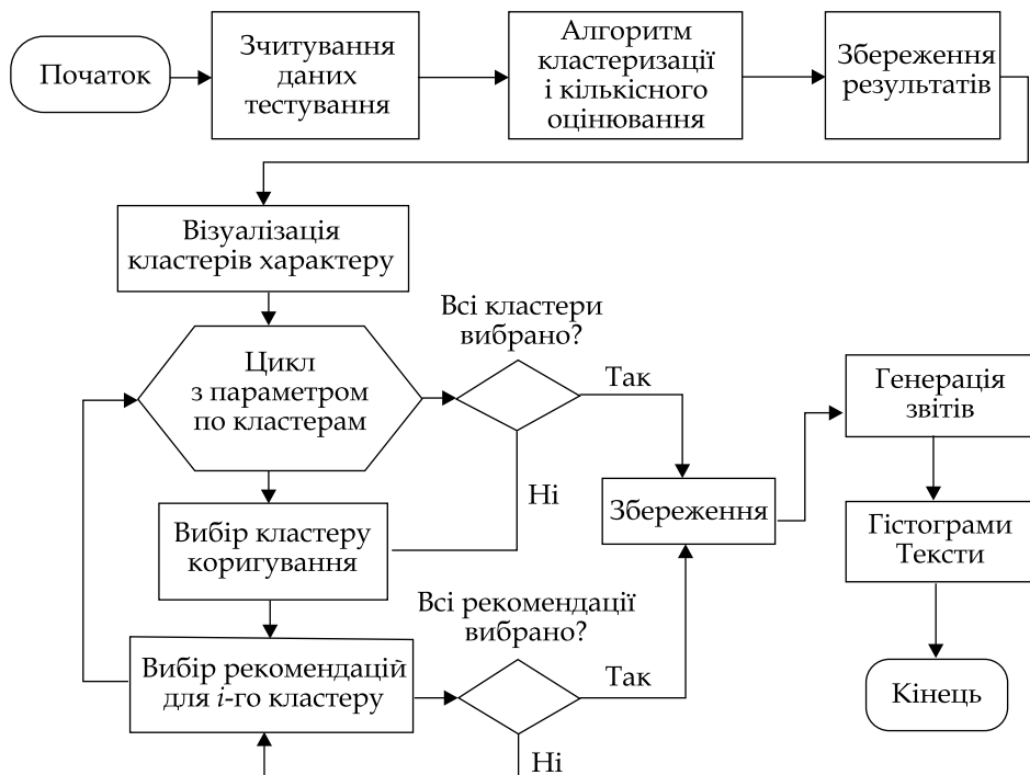
Рис. 3. Принципова блок-схема основного алгоритму роботи програми
