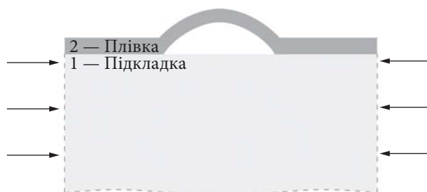
Рис. 1. Локальна втрата стійкості тонкої плівки на напівобмеженій підкладці
