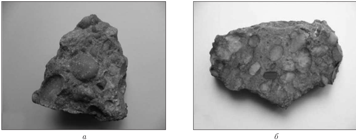
Рис. 1. Зовнішній вигляд білокоровицького конгломерату ( a — зразок 1 розміром по видовженню 11 см) та його аншліф ( б — зразок 2 розміром по видовженню 14 см)
