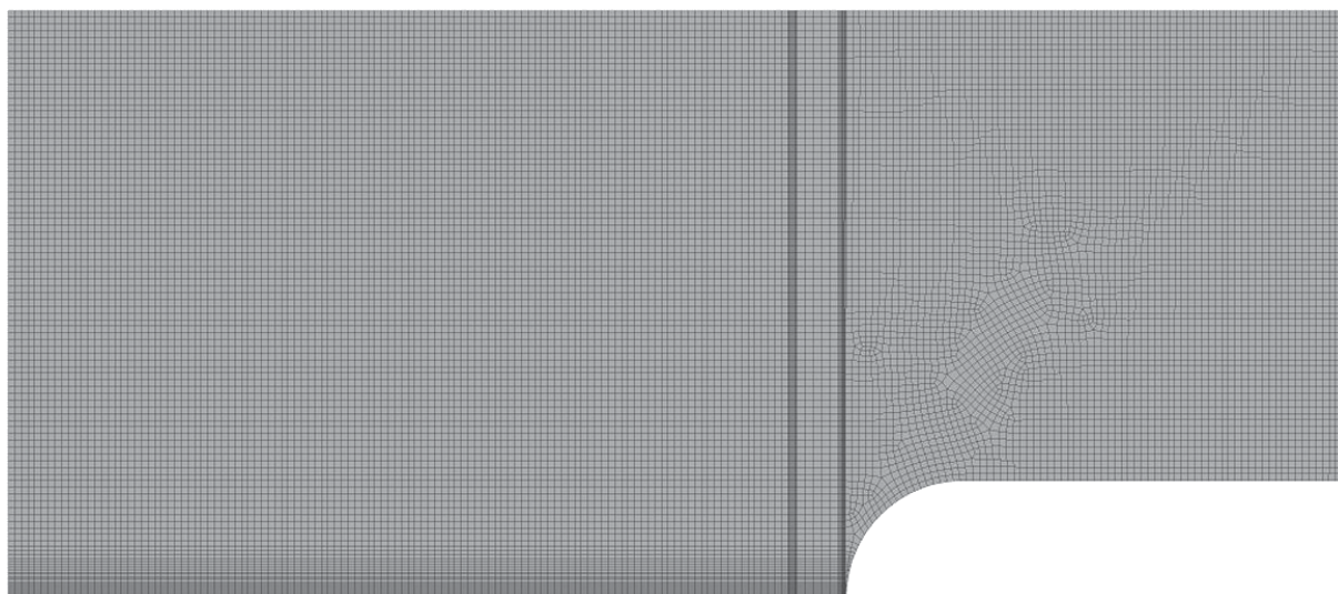
Рис. 2. Скінченно-елементна сітка розрахункової області для задачі обчислювальної гідродинаміки
