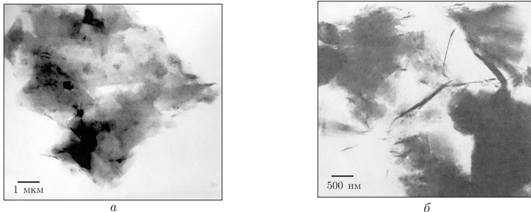
Рис. 1. Микрофотографии антрацита (а) и оксида графена (б)
